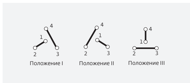
Рис.15. Возможные пути прохождения сигнала в T-переключателях
